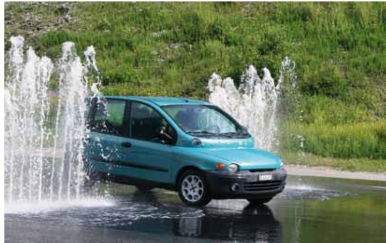
Zwei durch Wasser simulierte, plötzlich entgegenkommende Fahrzeuge
